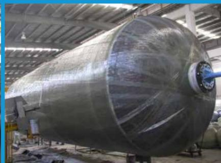
Bobinado de filamentos controlado por ordenador
