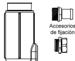
6. Coloque la carcasa del foco en el nicho del muro de hormigón o del suelo (Dibujo 3, Dibujo 4).
